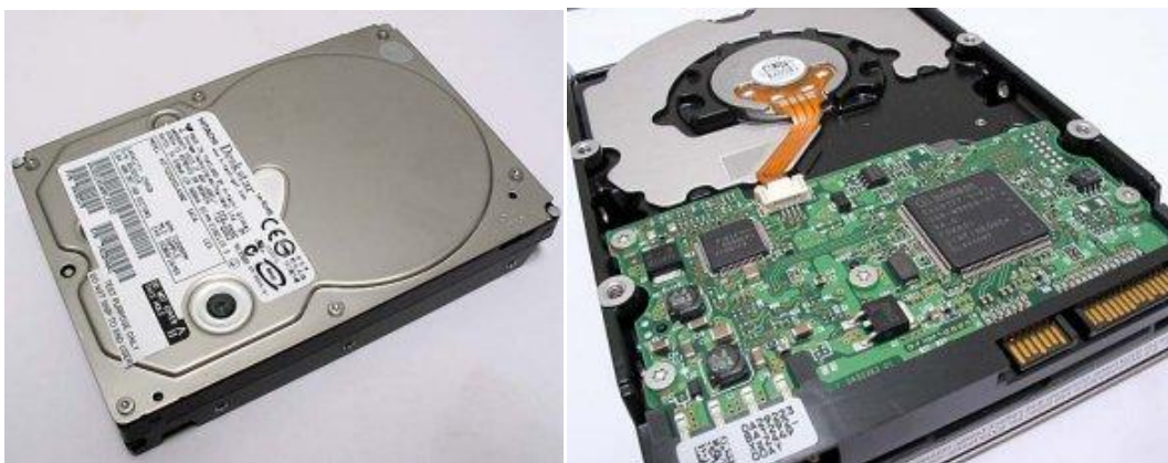
SATA harddisk fra Hitachi i lukket hhv. åben tilstand.
